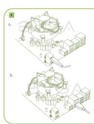
Plug in one keyboard into a USB port or PS/2 port. ひとつのキーボードのプラグをUSBポートまたはPS/2
