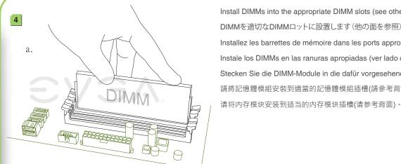
Install DIMMs into the appropriate DIMM slots (see other side). DIMMを適切なDIMMロットに設置します(他の面を参照) Installez les barrettes de mémoire dans les ports appropriés DIMM. Instale los DIMMs en las ranuras apropiadas (ver lado contrario) DIMM. Stecken Sie die DIMM-Module in die dafür vorgesehenen Steckplätze. 請將記憶體模組安裝到適當的記憶體模組插槽(請參考背面)。
